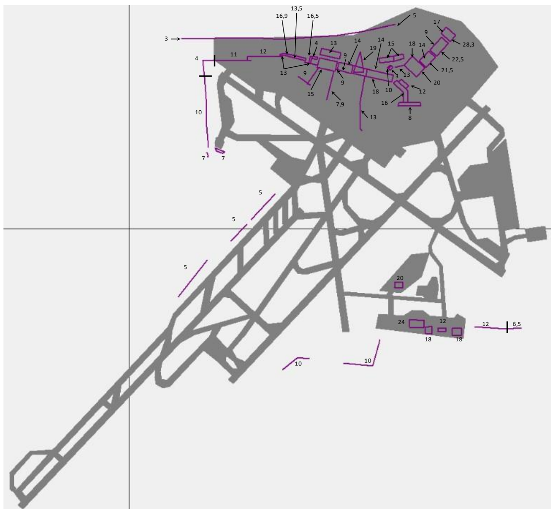
Figur 14 Placering af skærmende objekter (skærme, jordvolde og bygninger) med den i beregningerne anvendte højde.
